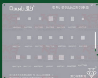
REBALLING STENCIL MXIM MAX SERIE QS71
