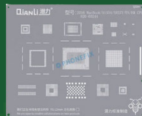
REBALLING STENCIL CPU 820-00244 QS94
